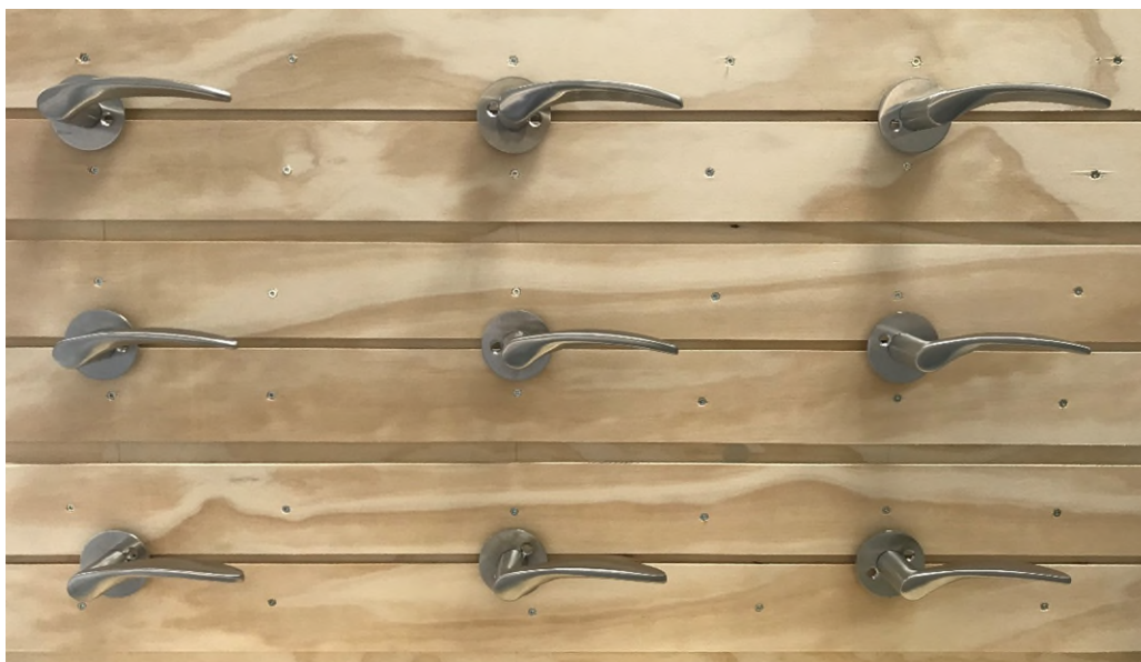
Figur 2: Testopstilling med håndgreb til udførelse af slidtest.
