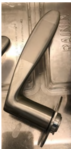
Figur 5: Test af den antibakterielle effekt. Plaststykket viser det testede område.
